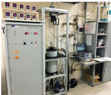
Внешний вид установки для калибровки высокотемпературных термопреобразователей
