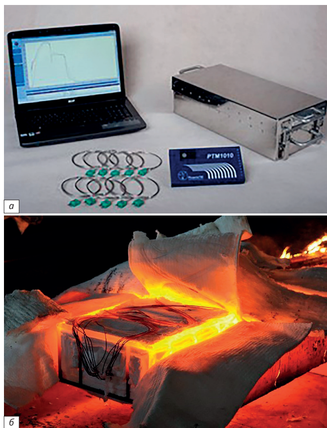
Рис. 1. Автономный регистратор температуры компании «Phoenix TM» и теплозащитный контейнер: а – составляющие системы; б – АРТ в сборе перед распаковкой системы
