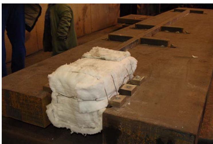
Рис.3 Заделка кабельных термопар в стальной сляб.
