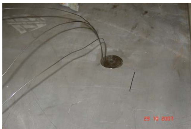
Рис. 1. Расположение термопреобразователей по сечению плиты.
