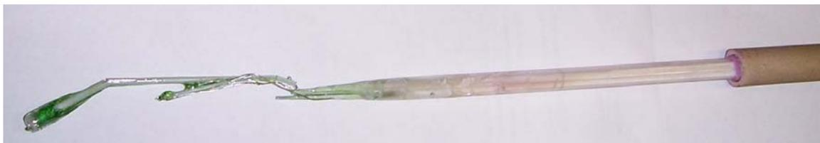
Рис.3 Результат взаимодействия лейкосапфира с цветным бутылочным стеклом при  $1200^\circ\text{C}$ .
