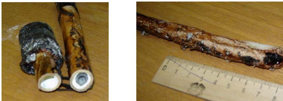
Рис.2 Термопреобразователь ТП-А после 1 мес. испытаний в стекловаренной печи (борное стекло, температура  $1570-1580^\circ\text{C}$ )
