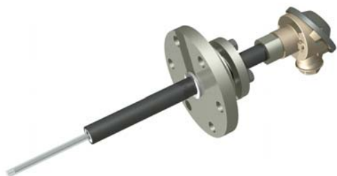
Рис.8. Герметичный вольфрамрениевый термопреобразователь в чехле из лейкосапфира для монтажа в вакуумной камере.
