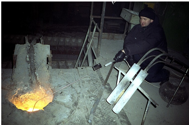
Рис.10 Измерение температуры расплава металла в индукционной печи с помощью термозонда
