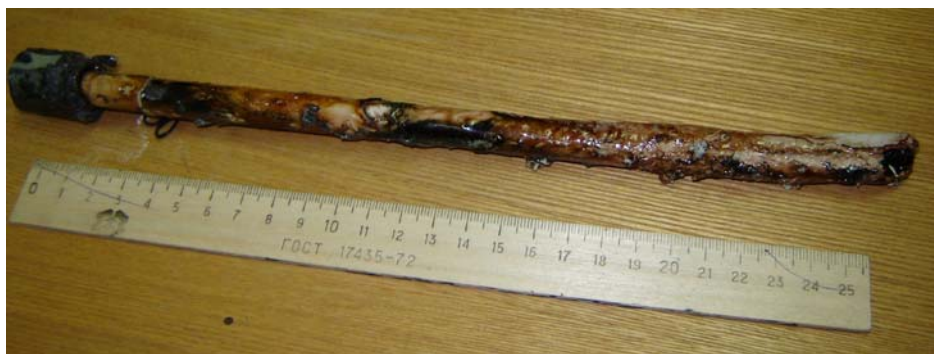
Рис.9 Термопреобразователь ТП-А после 1 мес. испытаний в стекловаренной печи (борное стекло, температура 1570-1580°C)
