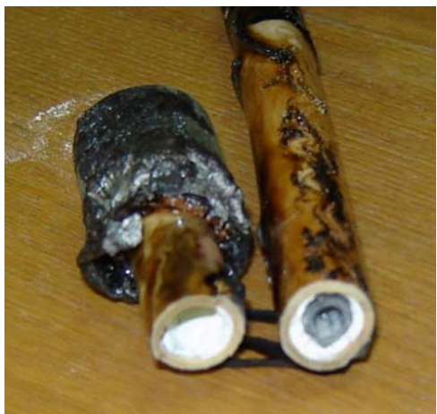
Рис.3 Термопреобразователь ТП-А после 1 мес. испытаний в стекловаренной печи (борное стекло, температура 1570-1580°C)
