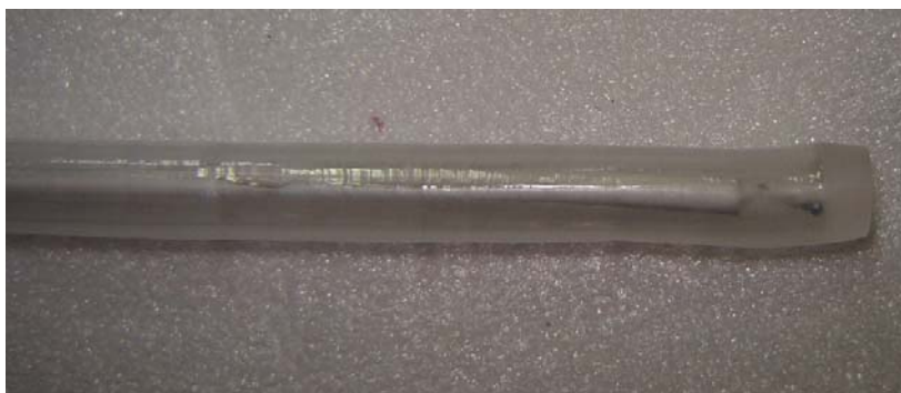
Рис. 9 Изменение калибровочной характеристики термопары ВР 5/20 относительно НСХ. (заводская комплектация 1990 г.в., термоэлектроды \varnothing 0,5 мм, гр.А-1)
