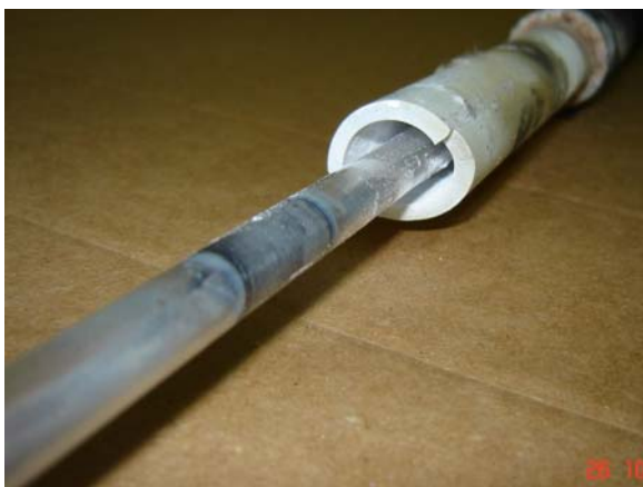
Рис.4 Термопреобразователь ТП-А после 3 мес. испытаний в стекловаренной печи (бутылочное стекло, температура ~1500°C)
