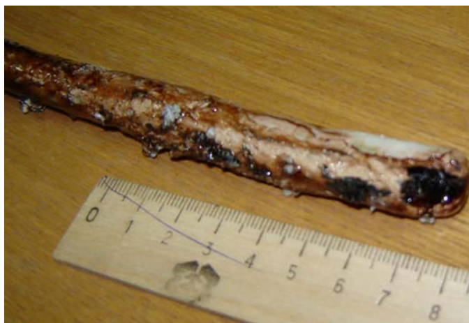
Рис.3 Термопреобразователь ТП-А после 1 мес. испытаний в стекловаренной печи (борное стекло, температура 1570-1580°C)
