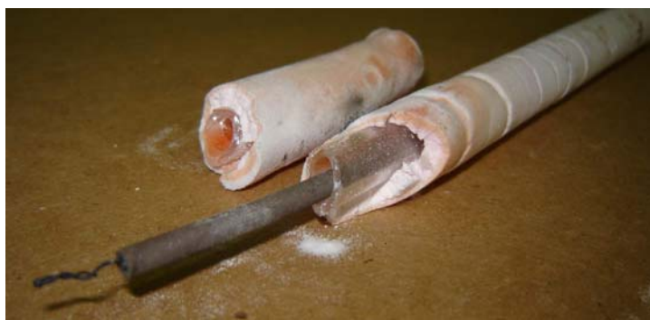
Рис.4 Термопреобразователь ТП-А после 3 мес. испытаний в стекловаренной печи (бутылочное стекло, температура ~1500°C)
