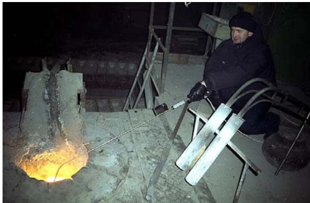
Рис.6 Измерение температуры расплава металла в индукционной печи с помощью термозонда
