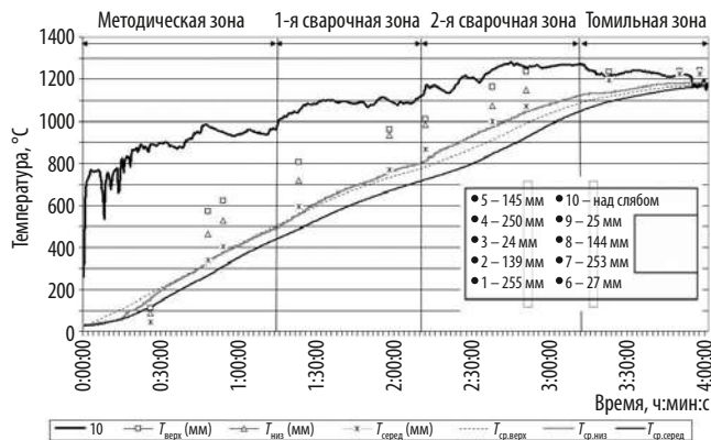
Рис. 3. Изменение температуры в контрольных точках сляба и расчетные значения математической модели
