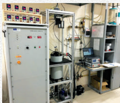
Внешний вид установки для калибровки высокотемпературных термопар (УКТ-2200) и её Аттестат №2411/0042-2020 от 13.01.2020 г.
