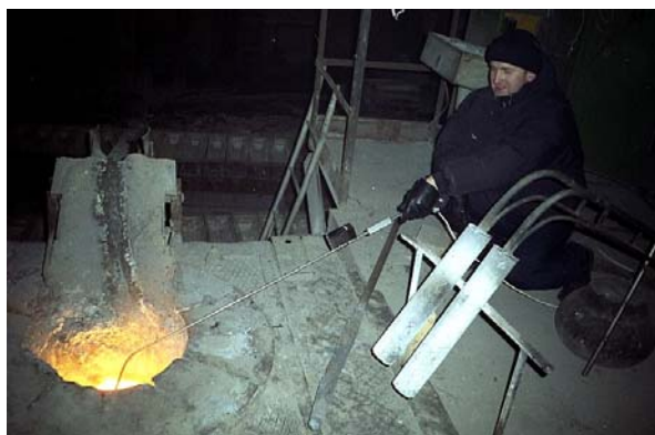
Рис.5 Измерение температуры расплава металла в индукционной печи с помощью термозонда ТП-А 212
