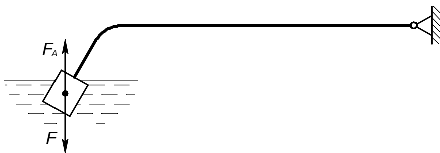
Рис.4. Схема термозонда, погруженного в расплав, и силы, действующие на поплавок
