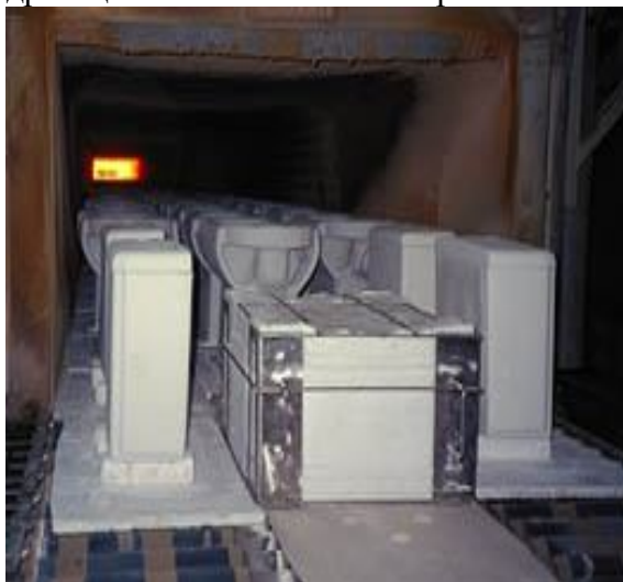
Рис. 3. Установка защитного контейнера с регистратором перед пуском в печь.
